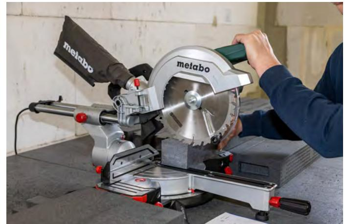
Preporučeni alat: Mitra pila sa oštricom grubog uzdužnog reza (npr. blaugelb HW list pile 250x3,2/2,2x30 mm Z24 W br. artikla 0399564).
