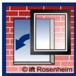
Luftdurchlässigkeit der Fuge Blendrahmen / Zarge bis zu ± 1000 Pa nach simulierten Kurzzeitbelastungen (Temperatur, Wind, Nutzung)
